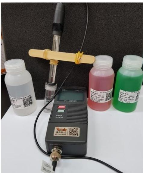
電極液、電極、電導度計與酸鹼校正液
