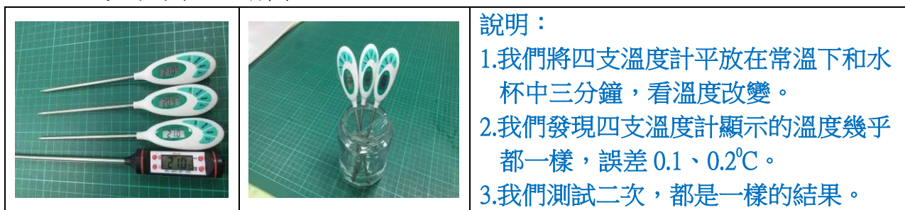
圖 5-2-7 探針式溫度計溫度測試結果說明圖
