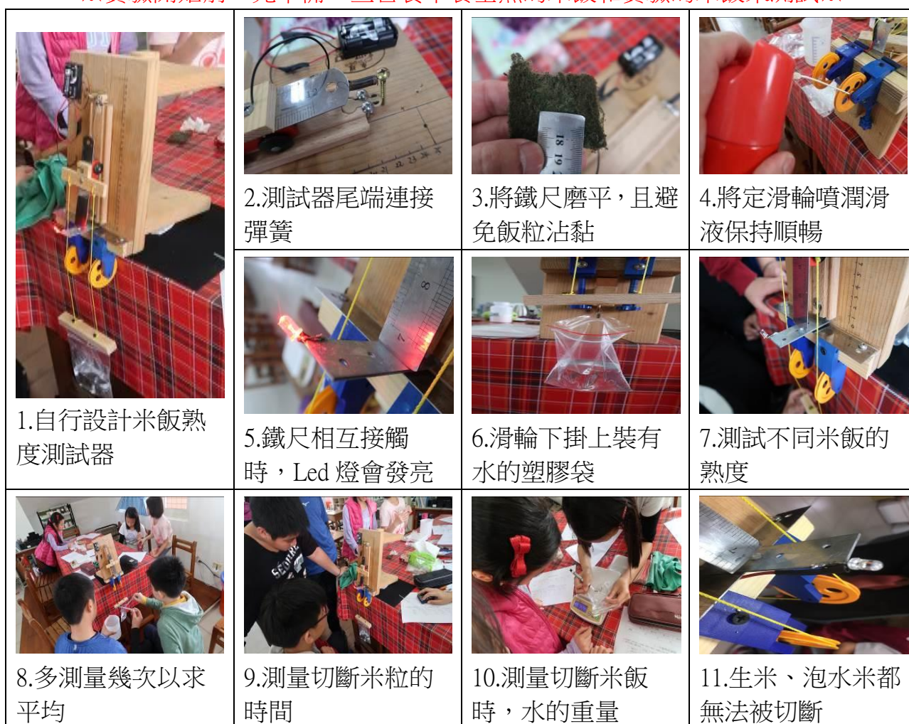
圖 5-2-4 自製米飯煮熟測試器測試結果說明圖
