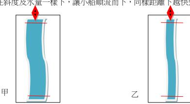
但討論後覺得無法製造相同的水量,所以不採用。後來採用單一水道,但水道有明顯的寬窄不一,只要量測寬窄兩個地方的水速即可,但要解決的部份是測流速的儀器,提出的建議有,一是利用小型水力發電機,連接測電池電量器,當水速越快,代動發電機轉動越快,測的電量會越高,相反就會越低,但實際上無法測得電量,可能電量極小無法測出。最後利用風速器當測水速器。
