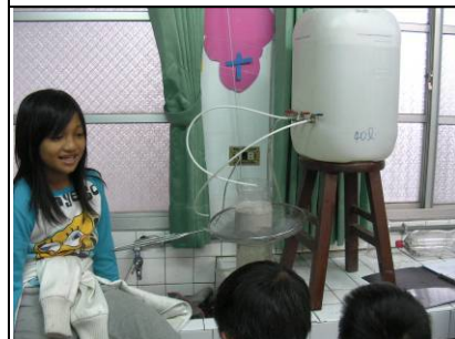
在水桶上設置開關，控制供水速度在每分鐘 100ml。
