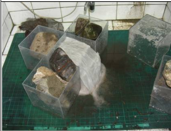
砂石層在衛生紙的保護之下，經水流的沖刷後結構沒有太大的坍崩。
