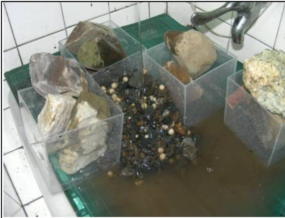
礫石在經水流的沖刷後形成小規模的坍崩
