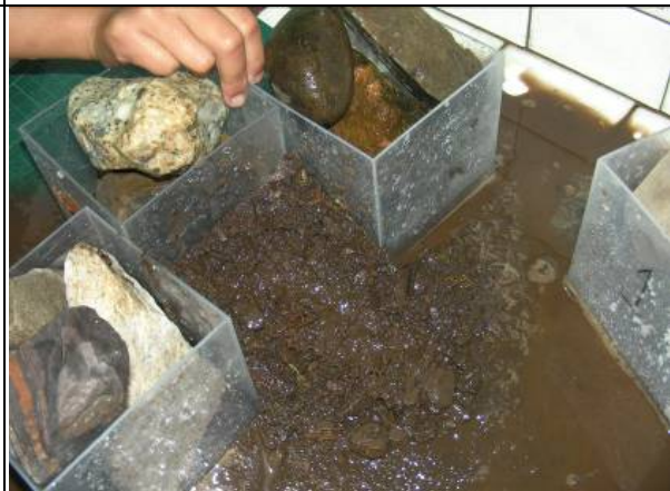
泥土在經水流的沖刷後形成大規模的坍崩，形成很大範圍的扇形沖積扇
