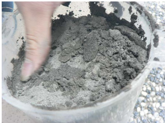
圖八、撥離上層砂土後，下層完全為乾砂土
