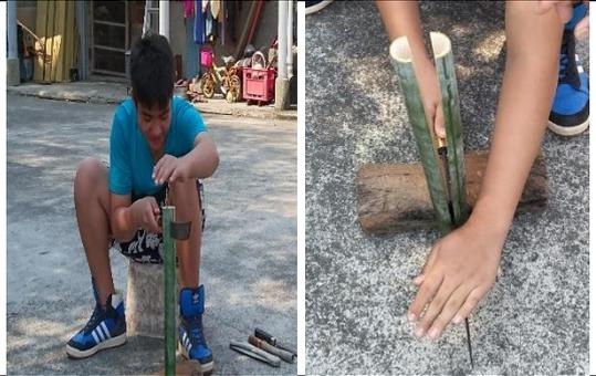
(3) 將剖一半的竹子根據需要的寬度再細分成數等分。(在竹子底下墊木頭的原因，是為了避免刀子直接接觸到地面，損壞刀子的鋒利度。)
