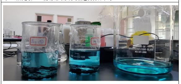
為了補足這次實驗的缺點,因此,我們重新用較小塊的石板來做實驗。 此照片為 107.04.13 (5天後),可以看出溶液的藍色顏色(銅離子)已較淡。 可見,石板顆粒愈細,愈能吸收
