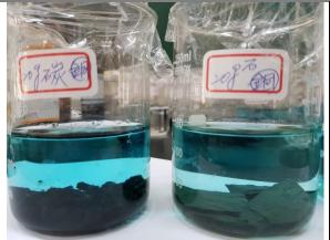
107.04.02 實驗照片(24 天後) 和活性碳做比較,石板硫酸銅溶液的顏色 有更明顯的變淡
