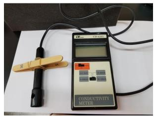
電導度計 (冰棒棍是固定電極的量測高度)
