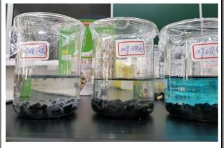
由左到右為 20g 活性碳的磷酸溶液、蒸餾水溶液,和硫酸銅溶液。結果蒸餾水和硫酸銅溶液都沒有藻華現象。
