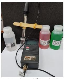
電極液、電極、電導度計與酸鹼校正液 (冰棒棍是固定電極的量測高度)
