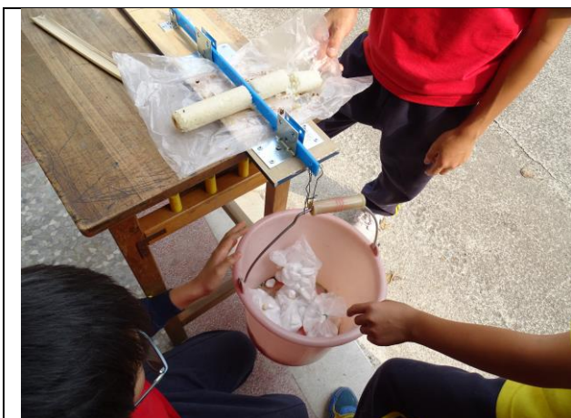
硬度實驗器，麻將尺模擬牙齒，水桶的重量就是牙齒咬斷竹筒飯所需的力。
