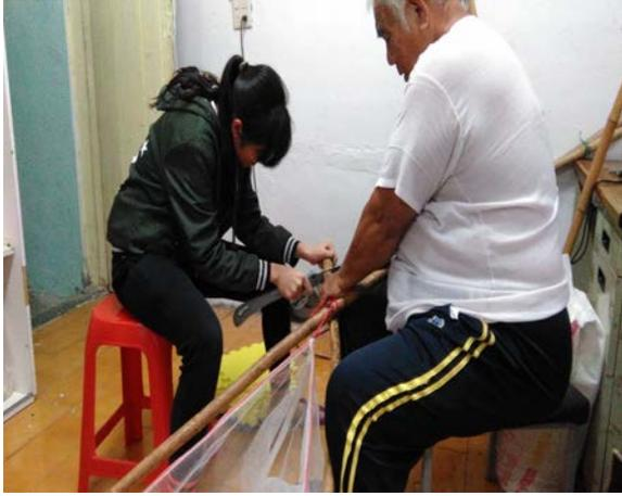
圖二十 竹節調整(將多餘長度鋸掉)
