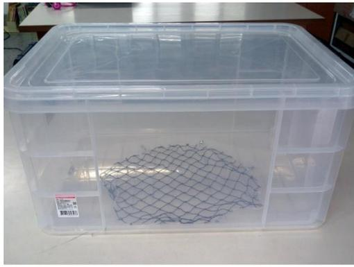
圖十八 鉛錘沉水實驗設備
