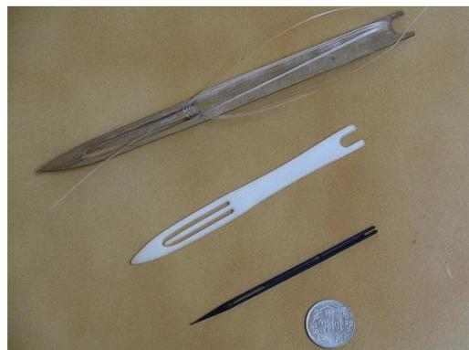
圖五 不同尺寸的補魚網工具
