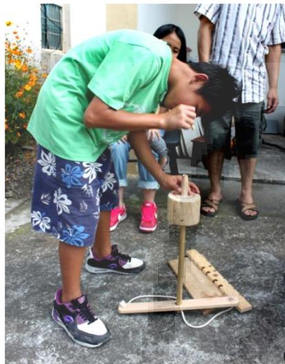
鑽木取火前，先將鑽木取火器具上面木棒棉繩纏繞好，然後手放置在橫木板上，順著往下施力，給予鑽木器一個力矩帶動底下的木材得以在鑽木板上快速旋轉，摩擦生熱，如此往返施力，就可以讓木材一直來回旋轉不停。
