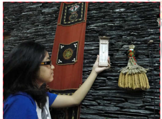
將最高最低溫度計放在多納村村口的石版屋裡
